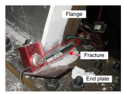
(d) Flange-to-end plate weld fracture
